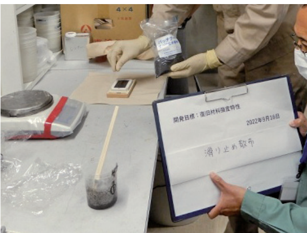
型枠に詰め込んだ材料の上部にスリップ止材料の敷設
