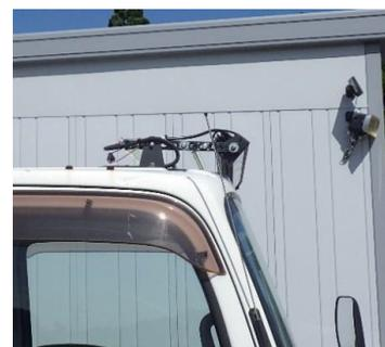
(その他苦労話等々) ※取付箇所が作業車は荷台屋根の上部、ユニック車はキャビンの天井部分なので、ライトの選定に苦労しました。小さいと暗く大きいと邪魔になってしまうし車用電力で補うので、使用材料としては細長くて明るく電力の少ない材料をさがしました。いろいろ調査した結果、車用の大型防水LEDバーライトを採用することにしました。ライトの高さは約8cm、長さは1.26m電源は288Wの材料を選定。取付については、荷台屋根上部については、ステー等による金物取付材により固定しました。ユニック車ですが、屋根上部に加工による穴をあけたくなかった為、ライトを強力な磁石ステーにて固定することにしました。規制品でマグネットステーが販売されていたので屋根上部に合うよう加工し、必要によって取り外しを可能にすることに成功しました。
